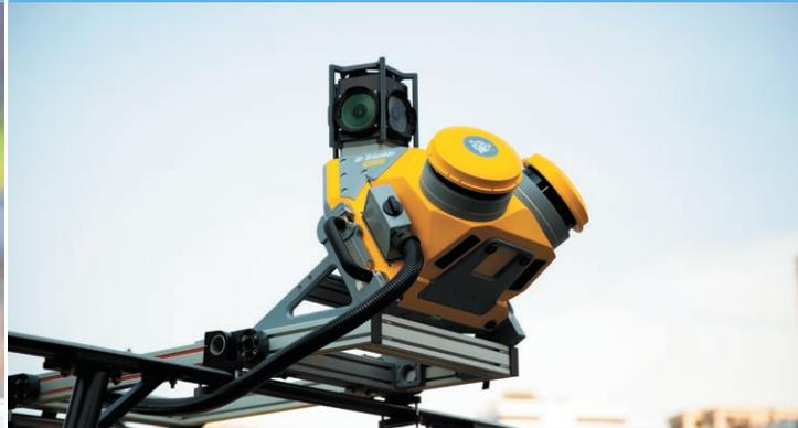
Trimble MX50 è una soluzione di mappatura mobile pratica, dal campo alla conclusione, per gestione asset, mappatura, e manutenzione stradale. Il sistema offre una nuvola di punti molto accurata dell'ambiente con immagini immersive, che fornisce un aumento sostanziale in produttività.
