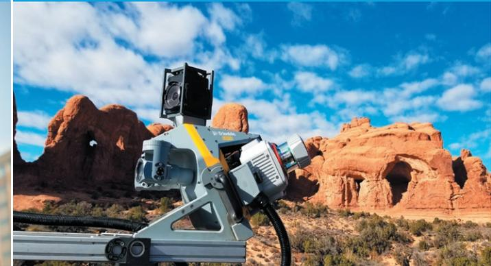
Trimble MX9 è una soluzione completa di mappatura mobile dal campo alla conclusione che combina top di gamma con un software da campo intuitivo e un potente flusso di lavoro integrato con il software da ufficio. Combina LiDAR a lungo raggio, immagini sferiche e fotocamere oblique con i migliori sensori inerziali per fornire le migliori prestazioni di mappatura mobile.
